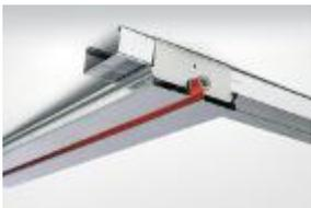
Das Raumklima-Profil kann direkt an die Decke oder an Dachbalken montiert werden. Die Rohrregister werden dann einfach in die Nut der Profile eingedrückt und an das Heizsystem angeschlossen.
